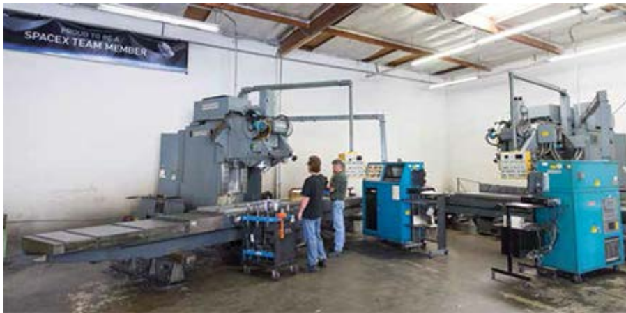
Sherwood の戦略は、Contour Engineering の多くの工作機械をオークションで入手し、新品のように作り直すことだ。Main Tech Enterprises がその仕事を行い、現在、2 台の Cincinnati Milacron C-Frame を、現場の難削材加工側で作り直している。
