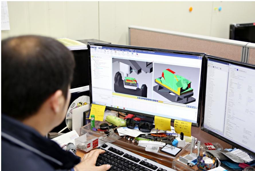
DaehanENG では、5 軸マシンで行う 906 件のジョブすべてだけでなく 3 軸製品すべてについても、ベリカットの検証、マルチアクシスモジュール、オートディフモジュールを使ってシミュレーションを行っている。
