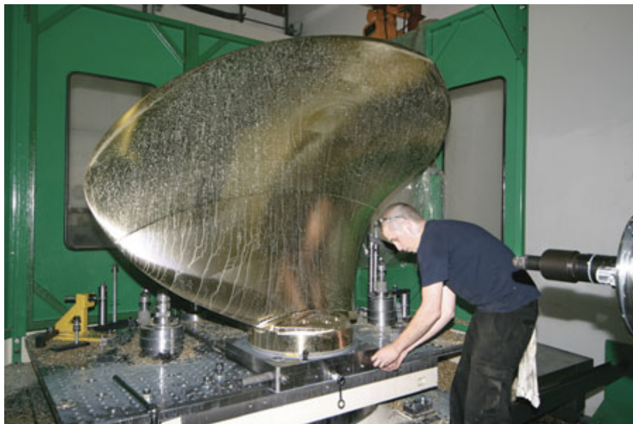
Dominis Engineering の工場では機械加工されるカナダの巡視船のプロペラブレード
