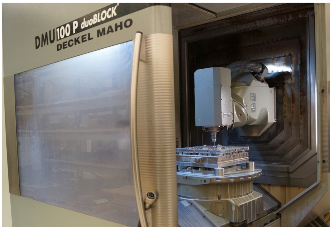
ペリカットでサポートしている複雑な金型の機械加工
