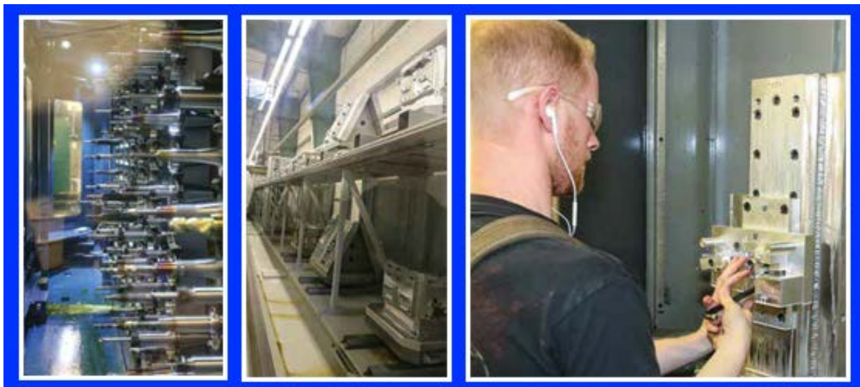
左：松浦の 5 軸機は両方共、それぞれ工具 240 本を持つ 中央：Fastems の 20 パレットシステムは松浦の両方の機械で共有され、さらに 10 パレットと別のミリングセンターのためのスペースがある 右：Huffman が、マキノの 2 パレットの 1 つに治具を取り付けている
