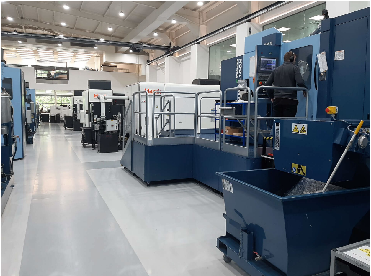
メルセデス F1 のブラックリー工場には、5 軸マシニングセンターやターンミルセンターが並んでいる
