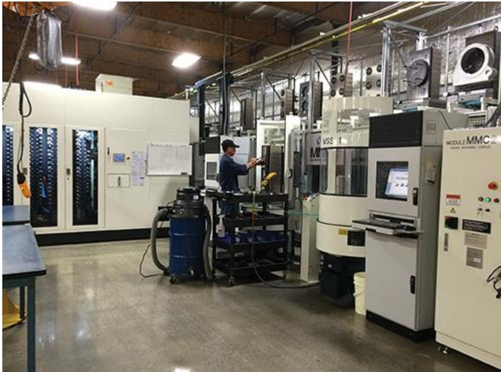
Micro-Mechanics は横型マシニングセンターとパレットシステムのフレキシブル生産システム(FMS)を生産現場に導入した。この自動化により、同社は機械加工の 6 製造ラインを、3 人のオペレーターで 24 時間稼働している。
