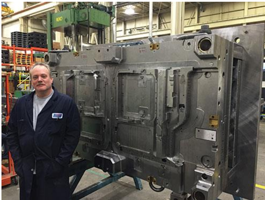
Mike Kearns が 2 重ドアパネルの金型の前に立つ。 これにはベリカットを使って機械加工した精密切削箇所が大量にある。
