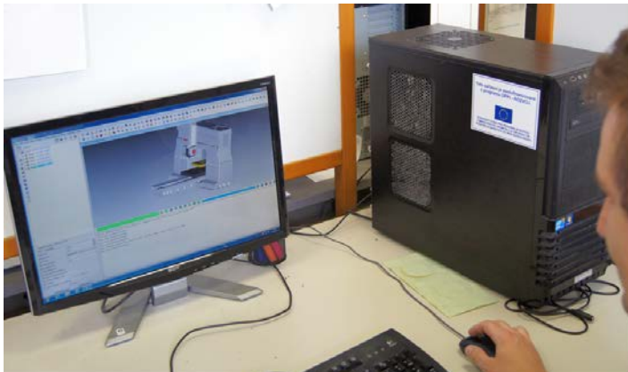
CAM プログラマーはペリカットの NC シミュレーションを同社の Huron 5 軸マシニングセンターに適用する
