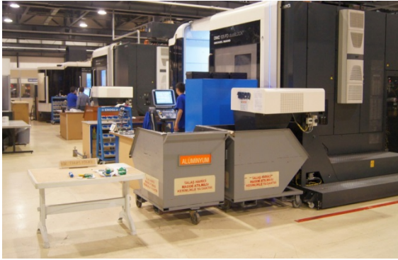
DMG の 5 軸ミリングマシン
