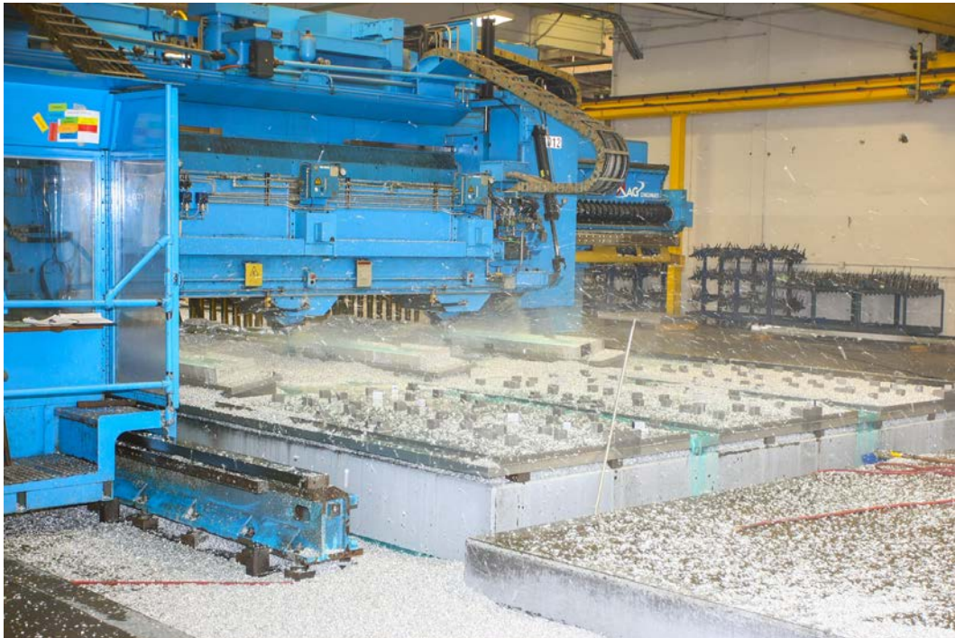
AMG では、最大 70 フィートの部品を 2000 in/分の送りで機械加工できる。 切子は D テイの薬莖のように機械から出てくる。
