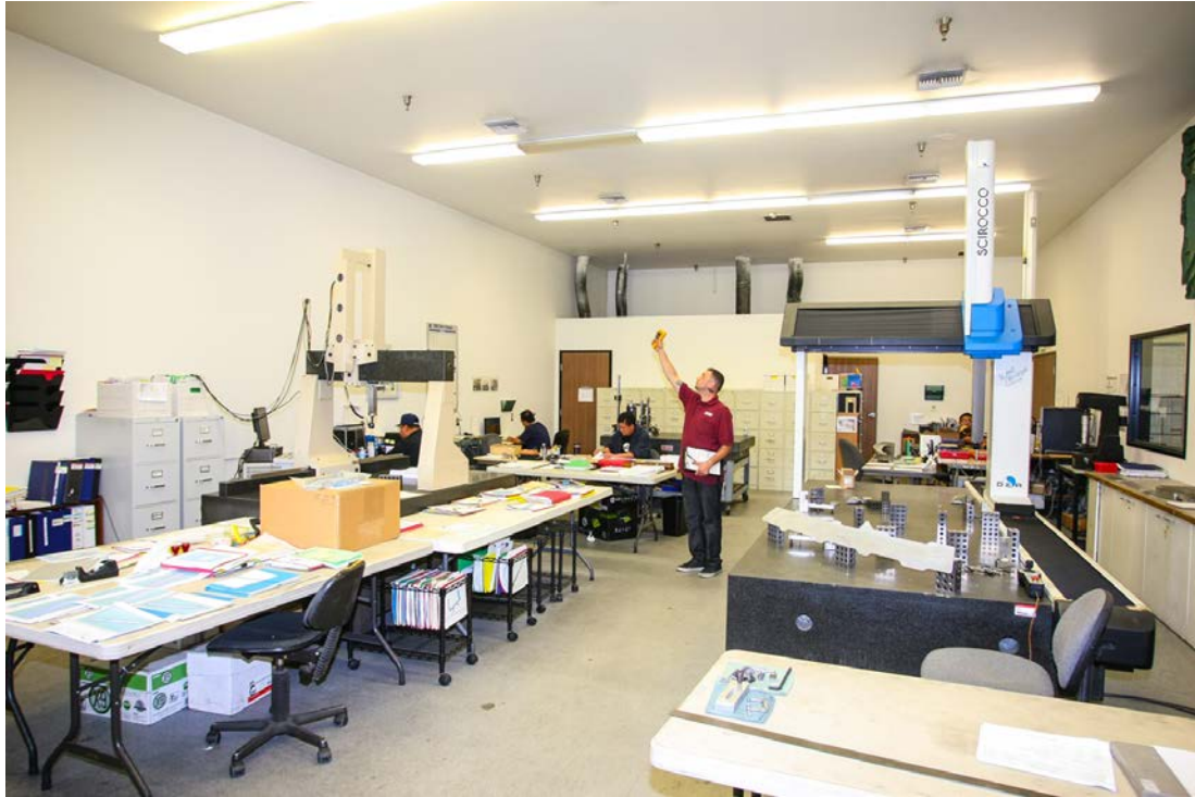
AMG の品質管理部には三次元測定機やレーザートラッカーがあり、航空機産業の厳格なガイドラインに対応している。機械に行く前に、多くの問題をベリカットで取り除いているため、できの悪い部品を彼らが受け取ることは、明らかに少ない。
