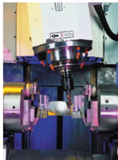
アルストムの生産環境にペリカットが導入される間、ブレードはめいっばい生産されていましたが、結果はすぐに出ました。以前には、プログラマーはプログラムのチェックに最善を尽くし、次に機械上でテストし、修正し、再テストということを要求されていました。今では、加工可能な NC プログラムを用意する時間が大幅に減らせる、とわかりました。「機械加工にもよりますが、部品のプログラムの時間を 5-10% 減らせます。かなりの生産性アップです」と Pfeufer が言います。さらに、工具、治具、ワーク、機械構造部品の干渉が事前に検出されるため、安全性も高まります。
