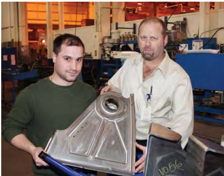
Ellanef では、航空機部品の機械加工を専門にしている。 シニア NC 部品プログラマー Greg Meservy (左) とエンジニアリングマネージャー Frank Dorsey (右) が民間航空機のチタン 5553 製の翼の部品を検査している。
