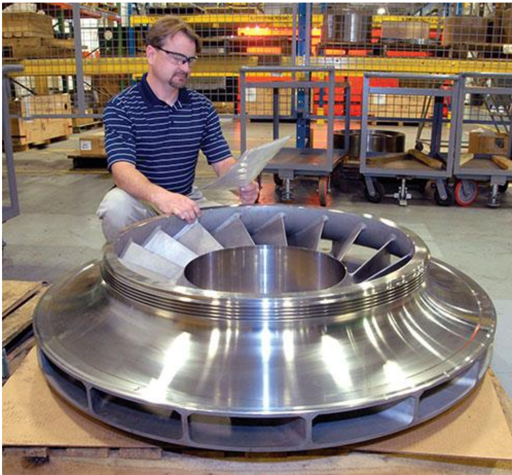
ローター事業部の機械加工と組立の監督、Ron Topper が遠心式コンプレッサーの大きなインペラーを見ている。ローター事業部で製作される部品の多くは直径 80 インチもある。
