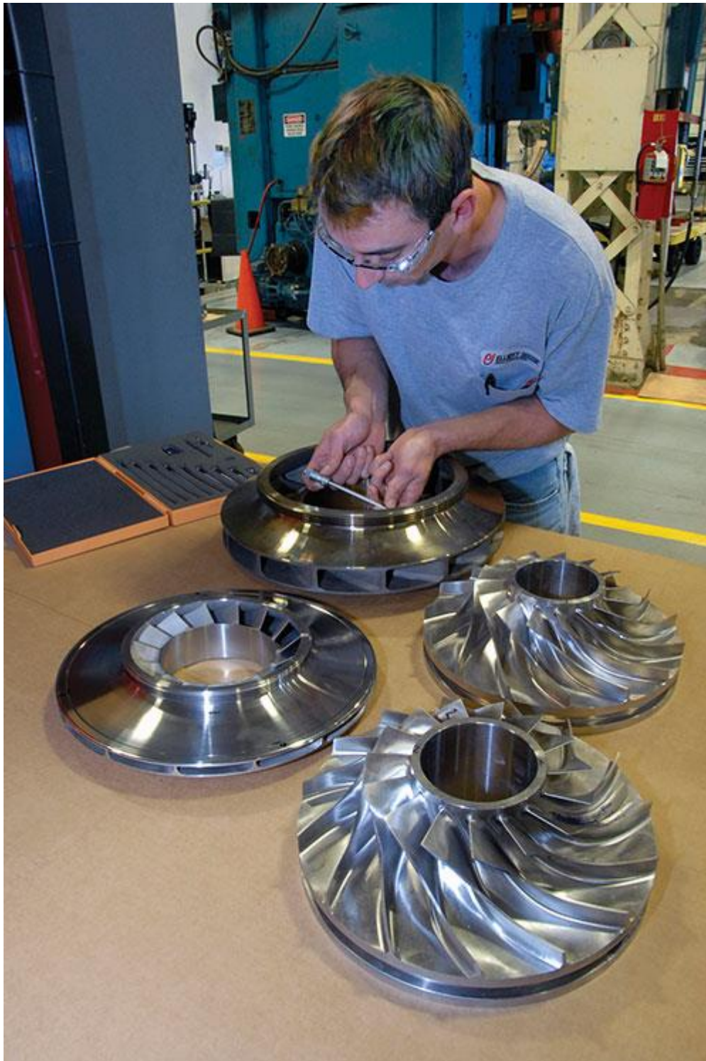
VTL のオペレーター、George Deitz は、遠心式コンプレッサーの小さなインペラーで作業している。ベリカットソフトウェアを使うことで、年間 27 個の廃棄部品はゼロになった。
