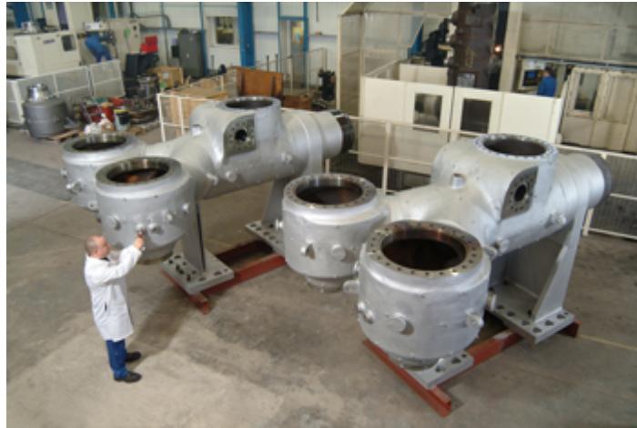
発電プラント産業の顧客へ納品する前の 600MW の RSV-ICV ユニット(LHとRH) 注記: RSV(再熱蒸気止弁)、ICV(インターセプト弁)、 LH(低圧加熱器)、RH(再生加熱器)
