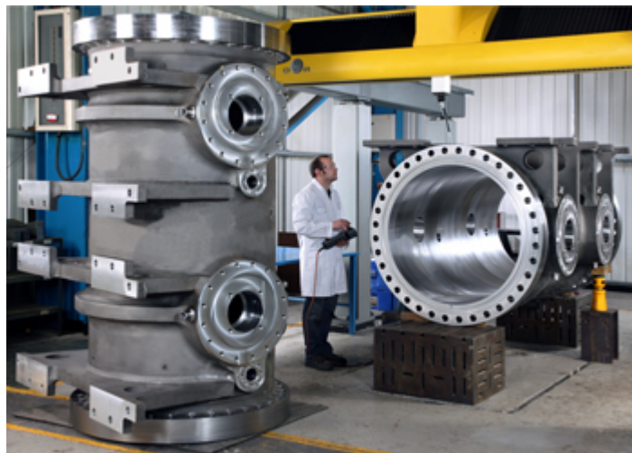
石油化学産業で使われる 84 インチの逆止弁
