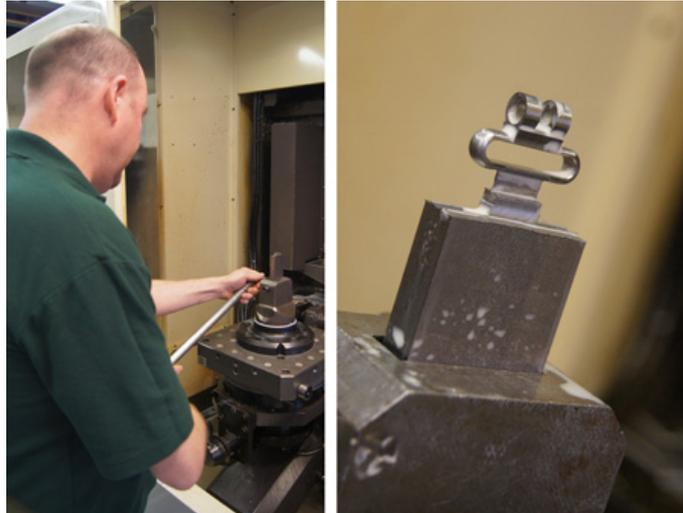
Rob Bishopp が素材のピレットを 5 軸の北村のマシニングセンターに取り付ける(左)。機械加工済のガンベルトのスイベル(右)
