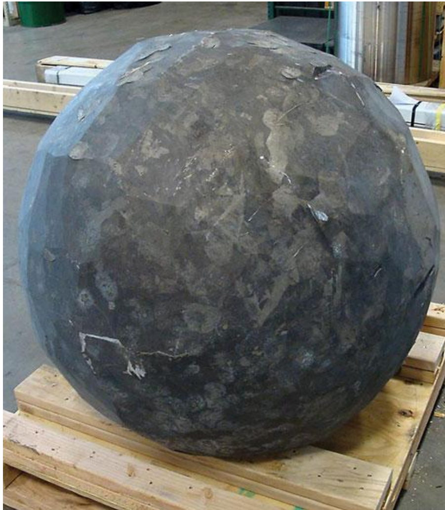
回折計の部品の出発点は、重量 3,000 ポンド(1.4 トン)の球形の鍛造アルミニウム
