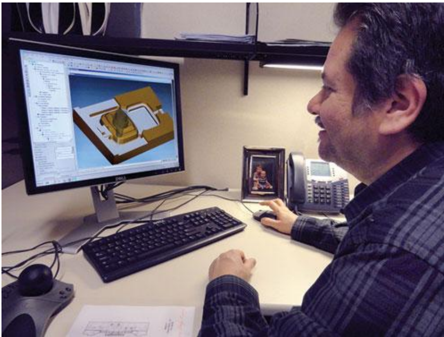
MGS の Rudi Garcia は、ベリカット CNC 機械加工ソフトウェアを使い、機械加工パスを検証する。
