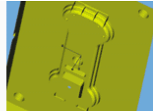
ベリカットで見るキャビティ設計モデルの最終形状
