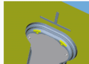
ベリカットによるキャビティのNCツールパス切削シミュレーション
