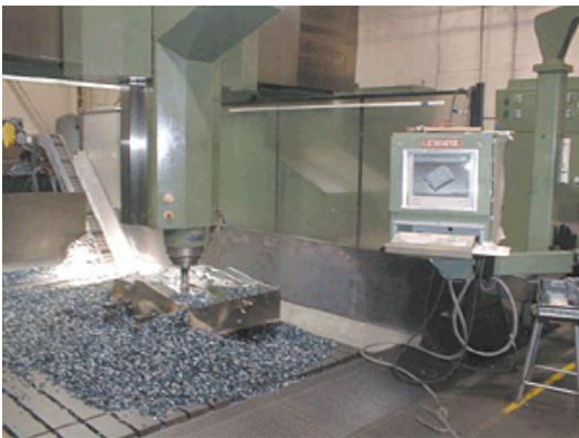
同社のほとんどのNC機械にはLemoine RTM/HSM現場プログラムシステムが装備され、ベリカットと一緒に、その場でNCプログラムの検証と最適化を行う
