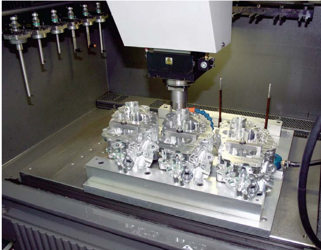
ビブりを回避し仕上げ面を改善するため、この会社はベリカットの オプティパスモジュールを使い、適切な送り速度を決めている
