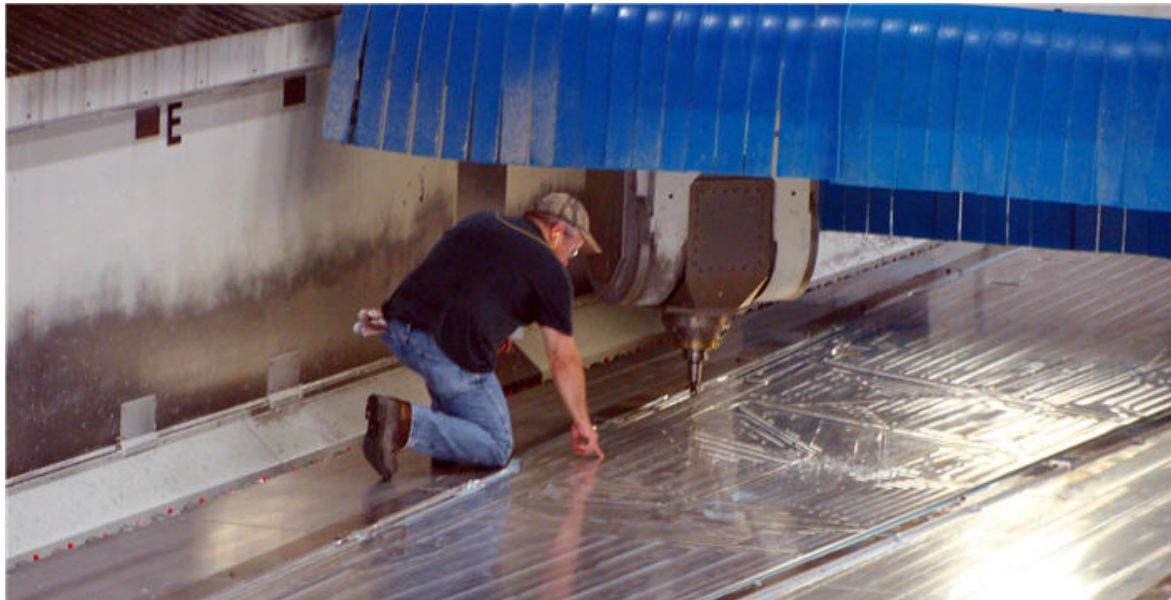
Handtmann UBZ ミリング機械で加工されている大型翼のスキンパネル NC オペレーターの Keith Butler がブレンド切削のチェックをしている
